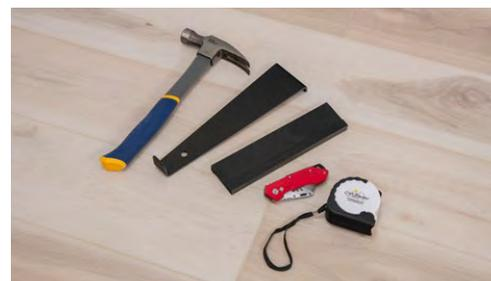
Due à la nature des planchers Cali Vinyl Longboards, il est acceptable d'utiliser la méthode avec couteau utilitaire pour couper les bouts excédents mais il est tout de même recommandé d'utiliser un banc de scie ou une scie à onglets pour plus de précision.
