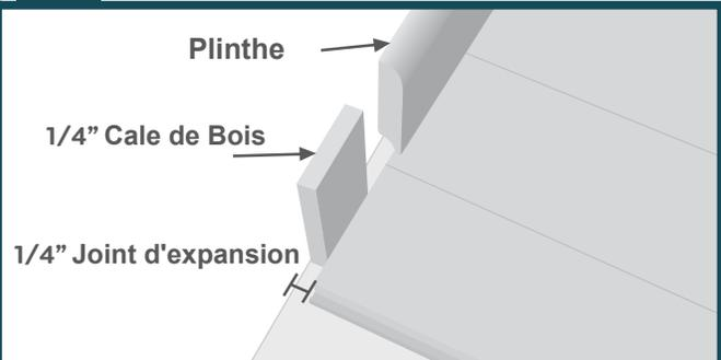
Laissez au moins 1/4" de joints d'expansion entre le plancher et TOUT objet vertical (murs, cabinets, etc.). De longues installations de plancher nécessiteront un joint d'expansion additionnel. Coupez le bas des châssis de porte pour allouer un espace adéquat d'expansion. Ne pas visser, clouer ou installer des cabinets ou autres objets permanents sur un plancher flottant.
