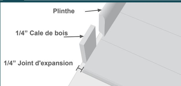
Laissez au moins 1/4" de joints d'expansion entre le plancher et TOUT objet vertical (murs, cabinets, etc.). De longues installations de plancher nécessiteront un joint d'expansion additionnel. Coupez le bas des châssis de porte pour allouer un espace adéquat d'expansion. Ne pas visser, clouer ou installer des cabinets ou autres objets permanents sur un plancher flottant.
